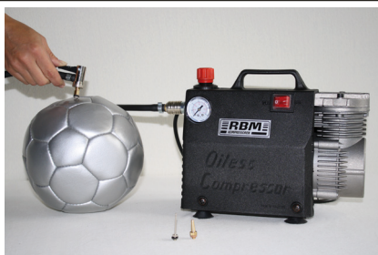
Ballkompressor MK 50 , ölfreier Membran-Kompressor, Zylinder-Gehäuse aus Alu-Druckguss mit Tragegriff, ca. 2800 U/min. Die Füllzeit für einen Fußball beträgt ca. 20 Sekunden, 1,2 m Schlauch, 2 Ballventile 1 Ventilhalter, ca. 6 kg Das Gerät ist völlig wartungsfrei, ca. 6 kg, TÜV geprüft
