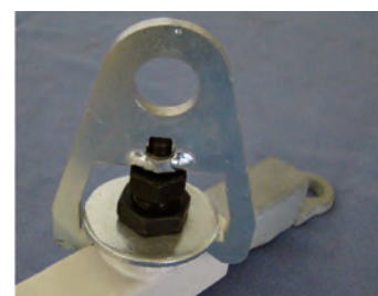
Rastblech mit Rastbolzen für Diagonalstrebe
