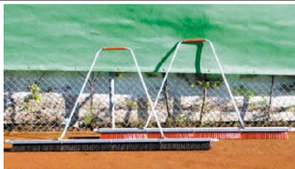
Tennisplatzbesen TOP 200 cm breit, zur Pflege des Spielfeldes direkt nach dem Spiel, bestehend aus 4 Besenteilen à 50 cm Länge, welche in einen ALU-U-Schienenrahmen geschoben werden, kpl. mit Bügel, seitliche Abweiser verhindern ein hängenbleiben im Netz oder Zaun
