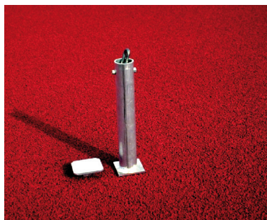
Erdanker-Versenkhülse zum Erreichen der vorgeschriebenen Netzhöhe in der Feldmitte, Länge: 250 mm, mit versenkbarer Oese und Abdeckkappe, Oberfläche: Alu-naturblank
